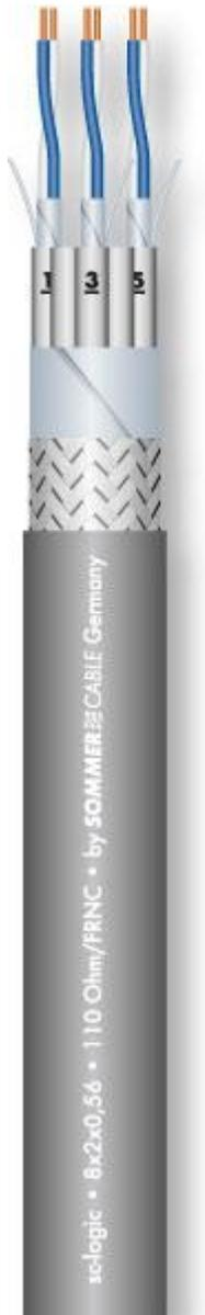
Symmetrisch, Adern Massivdraht, halogenfrei + flammwidrig, Aderpaare isoliert, mit AL/PT-Folie geschirmt + AL/PT-Folie und Cu-Geflecht-Gesamtschirm
