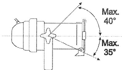
Regeln Sie den Neigungswinkel über den Montagebügel und ziehen Sie die Feststellschrauben fest an.
