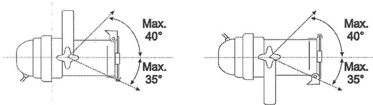
Regeln Sie den Neigungswinkel über den Montagebügel und ziehen Sie die Feststellschrauben fest an.
