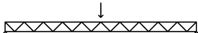
LF 2: Einzellast in Trägermitte, symmetrisch angeordnet in den mittleren Knoten des Untergurtes oder des Obergurtes.
